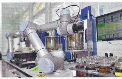
Oelcheck arbeitet auch für Privatpersonen, kann mittels Öluntersuchung frühzeitig Motorenverschleiß feststellen
